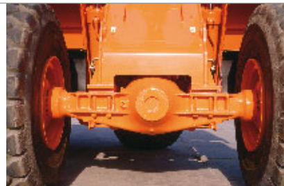
Assali abbondantemente dimensionati. Riduttori planetari finali per eliminare i sforzi tensionali negli assi.
