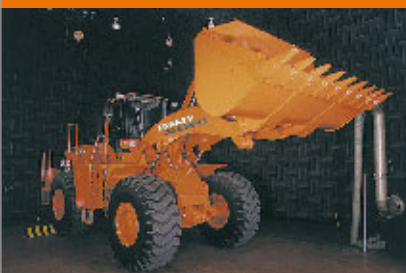
Misure del rumore e programma di riduzione nella camera fonoisolante.
