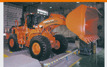
Simulazioni di condizioni di marcia (frenatura, accelerazione, sforzo di trazione, dissipazione del calore...).
