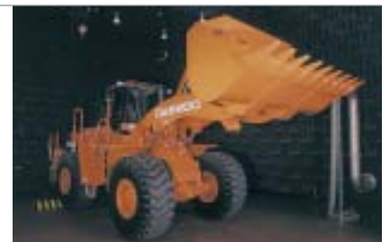
Misurazioni della rumorosità in ambiente insonorizzata.
