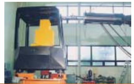
Le cabine sono testate secondo la normativa Rops/Fops.
